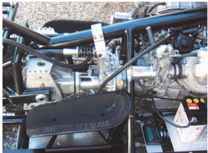
Der Winkeltrieb ist direkt am Getriebe angeflanscht. Eine Welle überträgt die Drehbewegung zum linksseitigen Ritzel. Die kleinen Dämpfer rechts und links des Rahmenhauptrohres federn die Hinterradschwinge ab. Die Lichtmaschine fiel den Sparplänen zum Opfer. Wir fahren auf Batterie.
