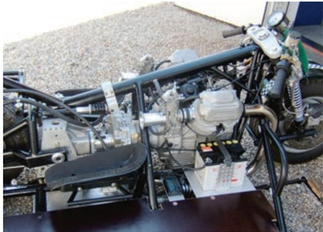
*Kneelergespanne sind sehr flach. Der Fahrer hockt sozusagen auf den Knien. Das Widerlager für die Hinterradstoßdämpfer ist stufenlos verstellbar.*
