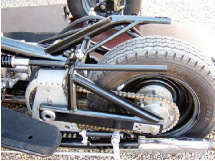
*Eine der vielen Besonderheiten ist der Kettenantrieb zum Hinterrad. Dieser ermöglicht das einfache Anpassen der Endübersetzung an die jeweilige Rennstrecke.*
