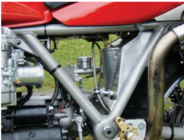
Der Ölabscheider bzw. Auffangbehälter paßgenau im Rahmen als Spritzschutz.
